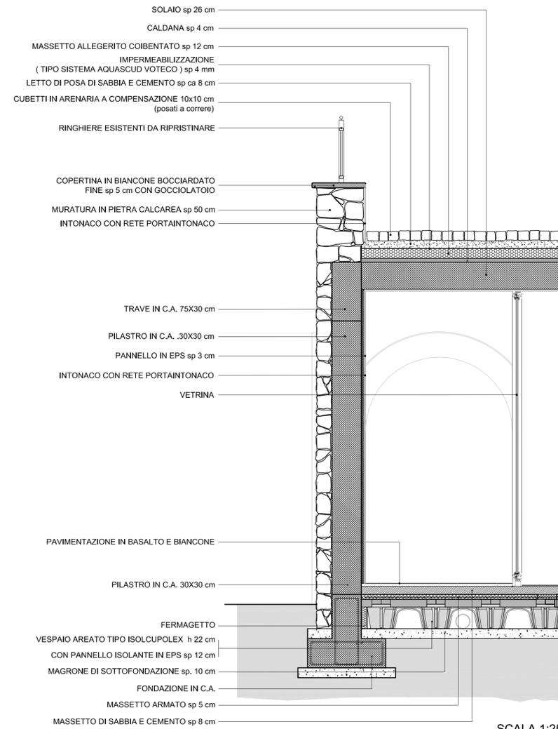
SEZIONE IN CORRISPONDENZA DI UN PILASTRO
